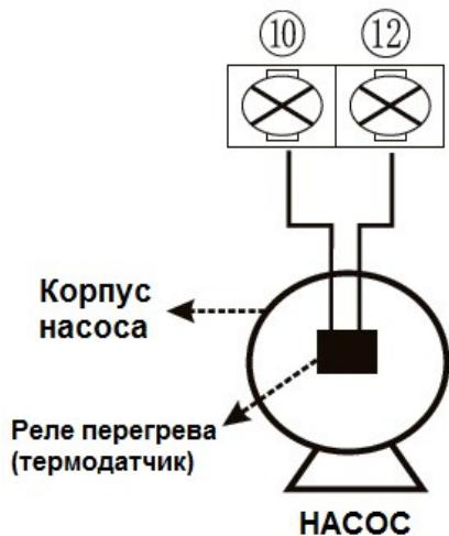
**Примечание №1:** для реализации защиты обмотки электродвигателя насоса от перегрева необходимо вмонтировать реле перегрева (термодатчик) в обмотку двигателя насоса
