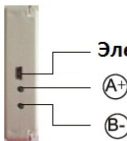
Вспомогательное устройство SC1 с коммуникационным интерфейсом позволяет удаленно контролировать работу (дистанционное управление). Соответственно находясь в служебном помещении пользователь имеет возможность управлять шкафом управления через данное вспомогательное устройство без настройки параметров калибровки и переналадки.
