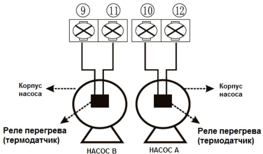
Примечание №1: для реализации защиты обмотки двигателя насоса от перегрева необходимо монтировать реле перегрева (термодатчик) в обмотку двигателя насоса
