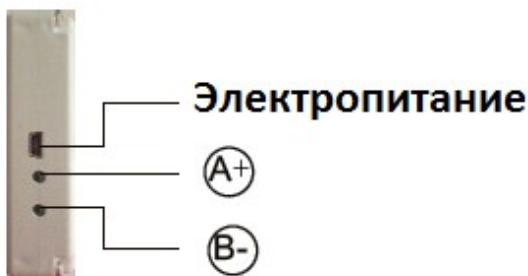
Ведомый контроллер SC2 с коммуникационным интерфейсом позволяет удаленно контролировать работу (дистанционное управление). Соответственно находясь в служебном помещении пользователь имеет возможность управлять шкафом управления через данное вспомогательное устройство без настройки параметров калибровки и переналадки.
