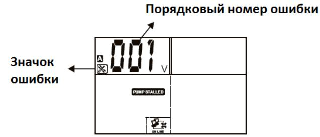
**Примечание:** Отображение последних 5 ошибок по насосу В аналогично отображению для насоса А, просто в ходе запроса нужно нажать кнопку **B STOP** вместо **A STOP**
