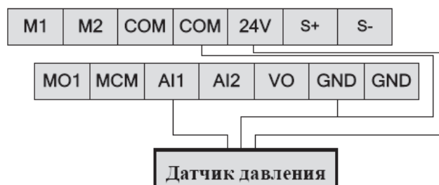
Трехпроводная схема подключения
